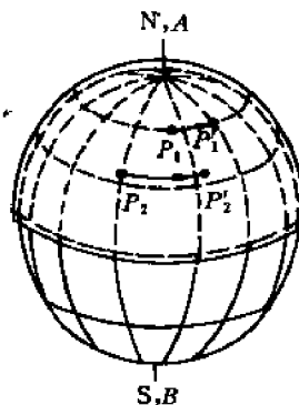
图 1-30 利用刻度球进行转动和测角的操作
