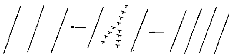
图 10-5 多边形化过程中Y结点的形成和移动
