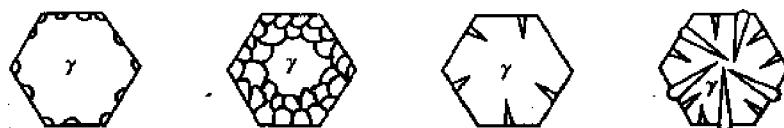
图 11-71 先共析铁素体形核长大示意图 (a) 晶界铁素体 (b) 魏氏组织铁素体
