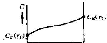
图11-47 两个不同半径的沉淀颗粒之间浓度曲线示意图
