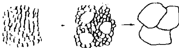
图 10-27 晶粒不均匀长大示意图
