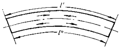
图 7-45 金属棒弯曲变形后的残留应力
