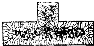
图3-31 中间凝固方式的缩孔和缩松
