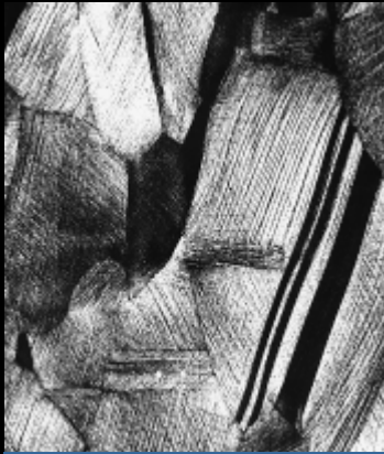
黄铜 冷变形33%
