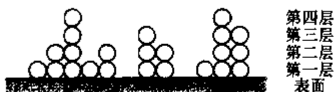
图 10.3.3 多分子层吸附示意图
