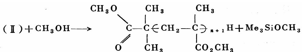
在聚合的每一步，三甲基硅基（-Si(CH<sub>3</sub>)<sub>3</sub>）不断地从大分子链末端转移到新单体的末端，形成新的活性中心。大分子链就这样如此反复地进行端基转移而形成聚合物，因此称为基团转移聚合。
