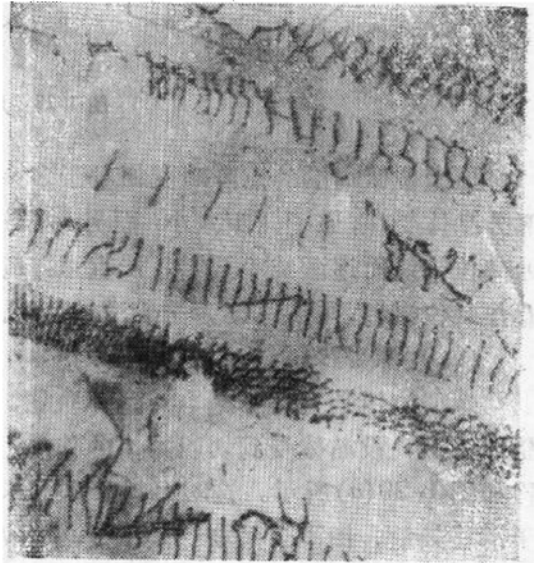
图 1-26 电镜下的位错 (18-8 不锈钢 10000×)
