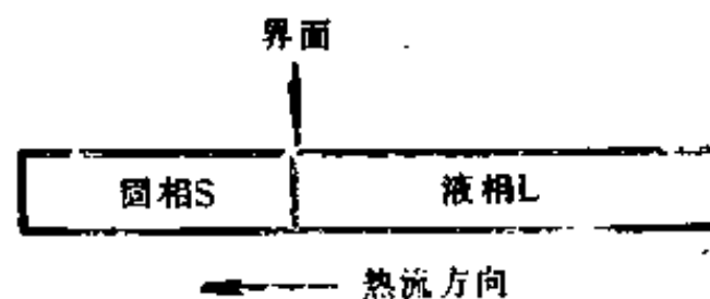
图 4.8 定向凝固示意图
