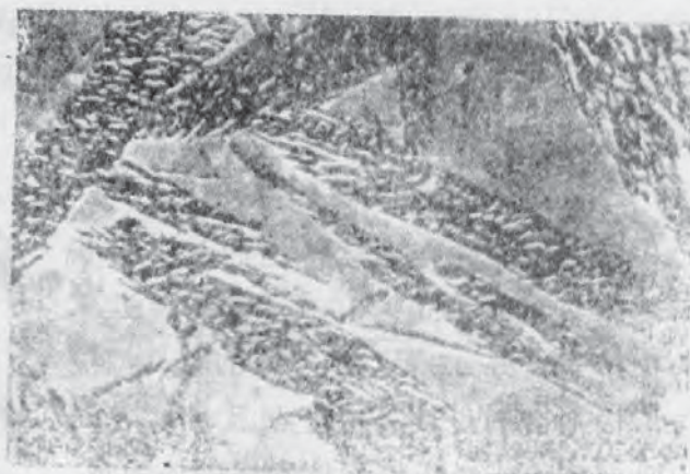
图 2-65 下贝氏体中的碳化物, \times 5000 (0.545C-1.2Cr-4.12Ni-0.43Mo-0.82W; 850^{\circ}\text{C} 加热 30min, 按 0.006^{\circ}\text{C}/\text{s} 冷却)
