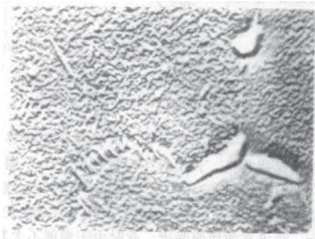
图 7-8 A-286 钢 760^\circ\text{C} 时效 200h 的显微组织 \gamma' 相弥散分布, 有 \eta\text{-Ni}_3\text{Ti} 小片, 晶界大块是 G 相, \times 8000
