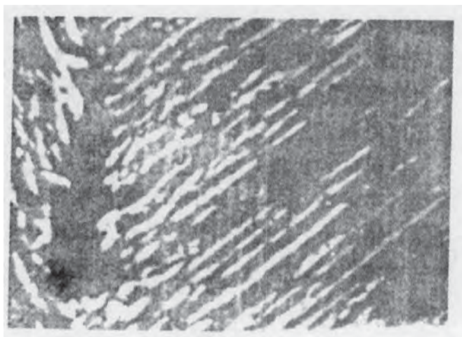
图 2-63 上贝氏体中的渗碳体 \times 5000 (60 钢; 900^{\circ}\text{C} 奥氏体化, 按 50^{\circ}\text{C}/\text{s} 冷却)
