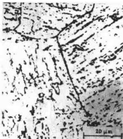
图 8.9 淬火低碳钢 ( w_{\text{C}} 0.18\% ) \alpha 相的回复组织 ( 600^{\circ}\text{C} 回火 10 min)
