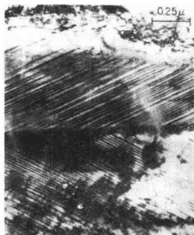
图 7.37 片状马氏体透射电镜照片
