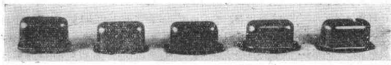
图7-48 继电器罩的冲压工艺过程
