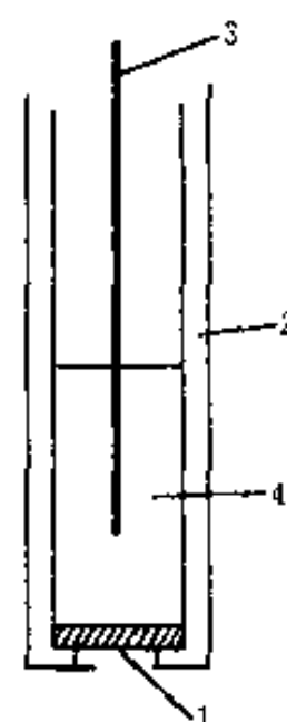
图 16-3 离子选择电极的基本构造
