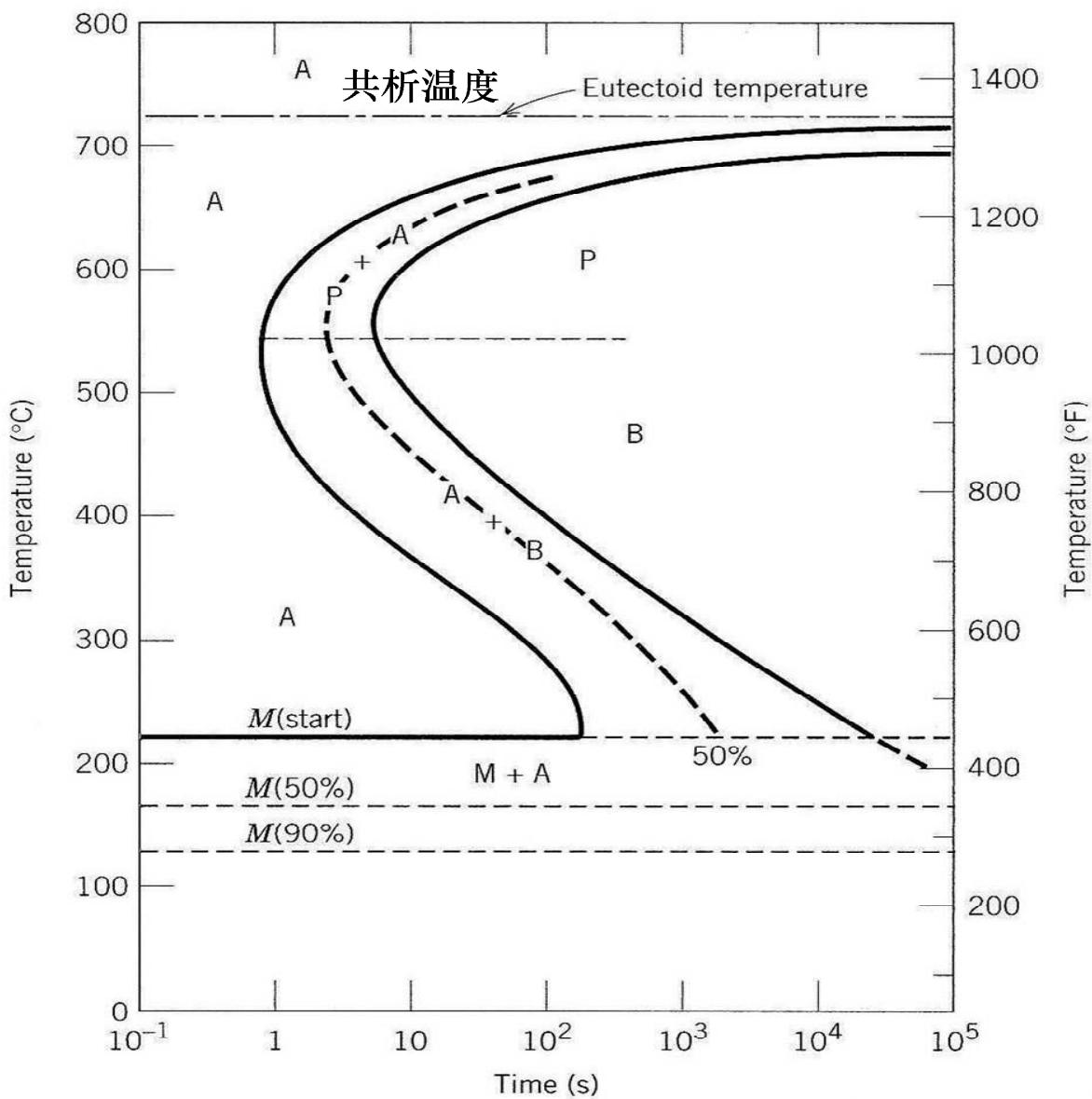
4. 某小工件由共析钢 (Fe-C) 制造, 该钢的等温转变图如上 (题 3 图) 所示; 假定该工件已充分保温而完全奥氏体化并从 760°C 开始冷却, 试确定该工件按下列三种冷却方式处理后的显微组织特征 (室温下为何种组织), 并阐述原因: (9 分)
