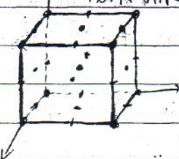
体心八面体间隙 (棱中点+面中心)
