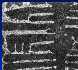
w(\text{Ce})=3\% 的Sn-Zn合金凝固后的暗场光学显微组织照片。黑的 树枝晶 是Sn的固溶体，基体是Sn-Zn共晶。
