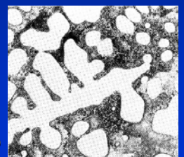
x(\text{Ce})=5\% 的Ni-Ce合金凝固后的光学显微组织照片。白的 树枝晶 是Ni的固溶体，基体是Ni-Ce共晶。
