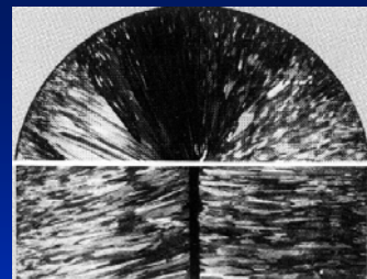
纯铜（直径4吋）铸锭的横截面（上）及纵截面（下）的铸造组织 0.6×
