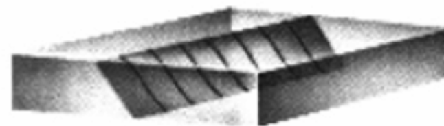
在薄膜中排列在滑移面上的位错的示意图
