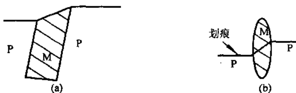
图 4-2 马氏体相变引起的宏观变形
