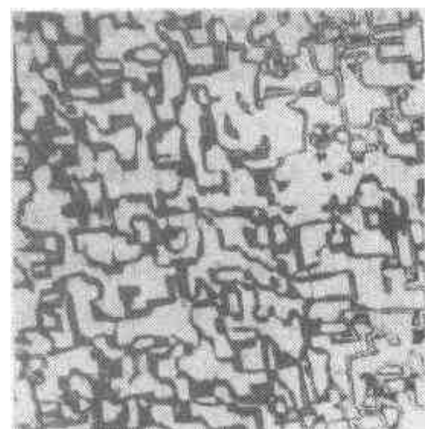
图 10-49 \text{Cu}_3\text{Au} 中的反相畴界, \times 32600
