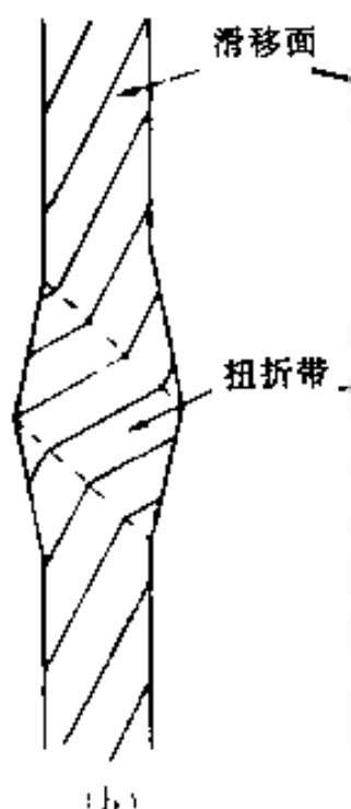
图 8-32 锌单晶体拉伸时出现扭折带外貌(a) 及描述扭折带的示意图(b)
