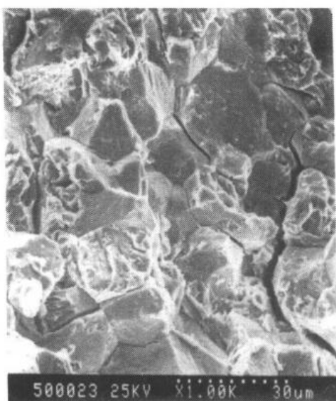
图 12-11 30CrMnSi 钢沿晶断二次电子像
