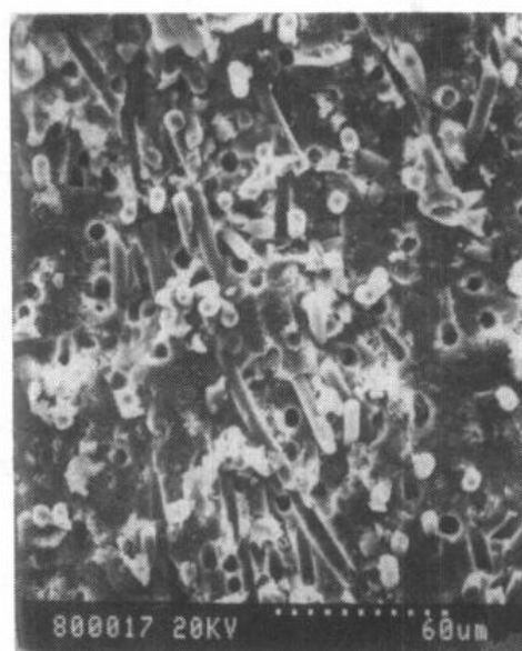
12-13 低碳钢冷脆解理断口的二次电子像
