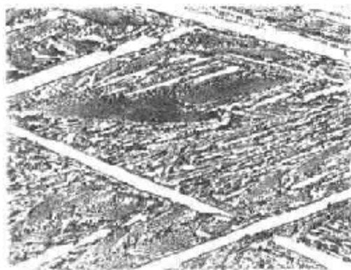
图 7.60 过共晶白口铸铁冷却到室温后的组织 (白色条片是一次渗碳体, 其余为莱氏体) 250\times
