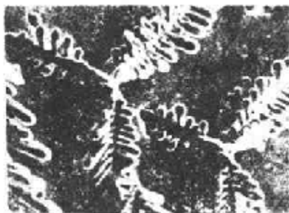
图 7.79 合金铸件的扫描电子显微镜照片(基体被选择性腐蚀掉而显示出 Co 树枝晶) 150×
