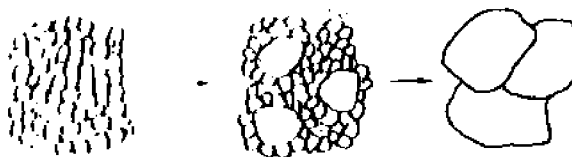
图 10-27 晶粒不均匀长大示意图
