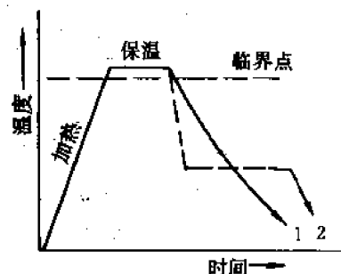
图 11-56 奥氏体不同冷却方式示意图 1——等温冷却 2——连续冷却
