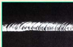
单晶锌变形后产生的滑移带 （采自C.F.Elam著 The Dislocation of Metal Crystals Oxford University press,1935）
