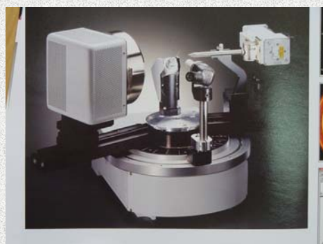
X射线衍射仪主要用于晶体结构分析和成分的半定量分析。
