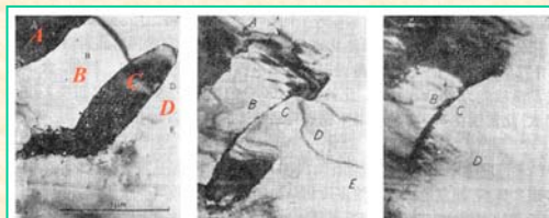
经98%冷轧的铝箔在透射电子显微镜中加热时所观察到的亚晶粒的合并 a) 多边化所形成的亚晶; b) 加热过程中亚晶C、D间的亚晶界部分消失; c) 继续加热时亚晶C、D间的亚晶界完全消失
