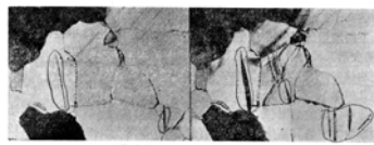
铜拉伸过程中孪晶的生长
