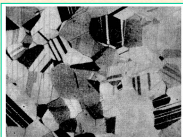
冷变形 \alpha 黄铜退火时形成的退火孪晶组织
