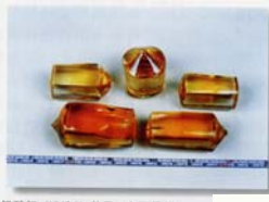
钇酸钇 (YVO4) 单晶，主要用于制作光通讯器件
