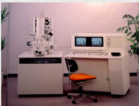
扫描电子显微镜主要用于表面形貌观察、化学成分分析及部分晶体学研究工作。
