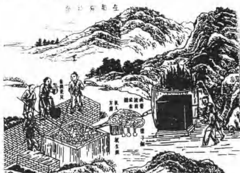
图 3-9 串联式炒钢法 (明代生熟铁冶炼图，载《天工开物》)
