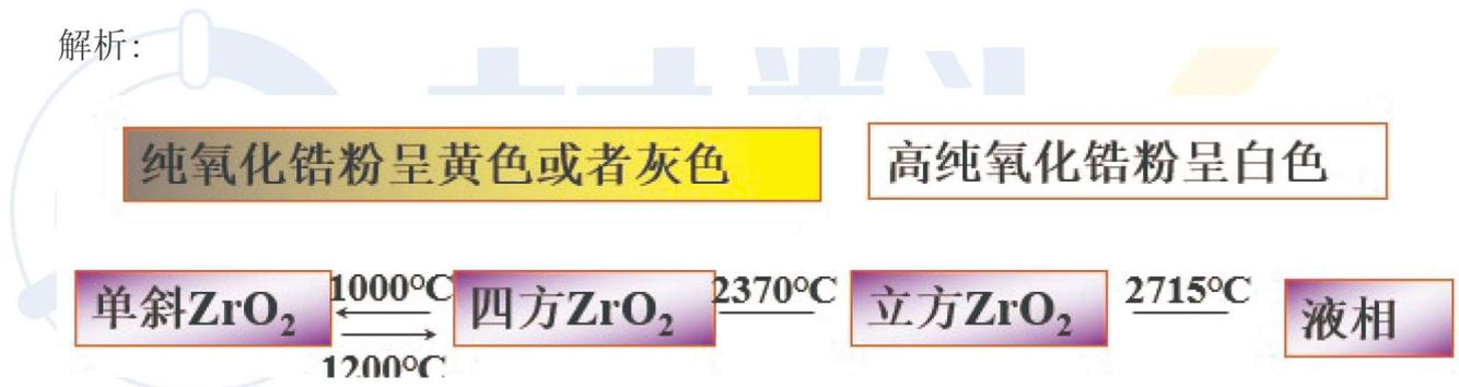
由单斜相向四方相转化时会伴随有 7% 左右的体积变化。加热时由单斜  $\rightarrow ZrO_2 \rightarrow$  四方  $\rightarrow ZrO_2$ ，体积收缩。冷却时由四方  $\rightarrow ZrO_2 \rightarrow$  单斜  $\rightarrow ZrO_2$ ，体积膨胀。但这种收缩与膨胀并不发生在同一温度，前者约在  $1200^\circ C$ ，后者约在  $1000^\circ C$ 。
