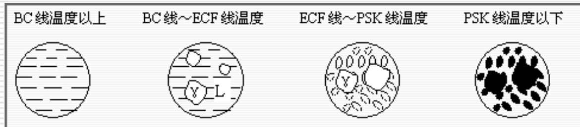
亚共晶白口铁结晶过程示意图
