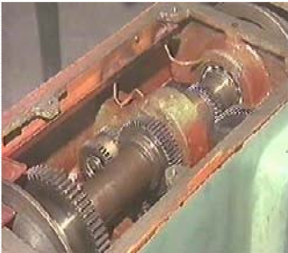
机床变速箱齿轮
