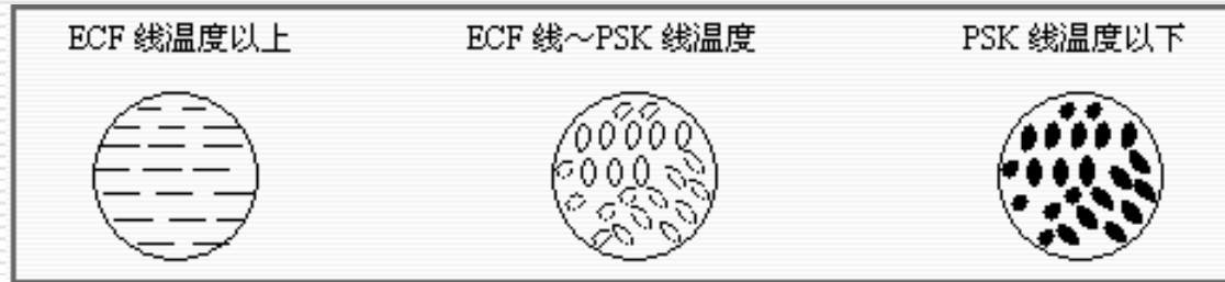
共晶白口铁结晶过程示意图
