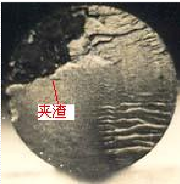
对焊刀具毛坯焊缝的夹渣
