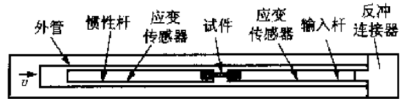
图 8-13 直拉式拉伸试验装置
