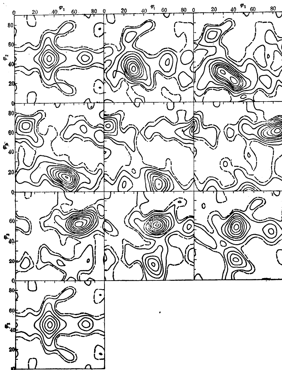
图 12-20 冷轧铝箔恒 \varphi_2 的ODF截面
