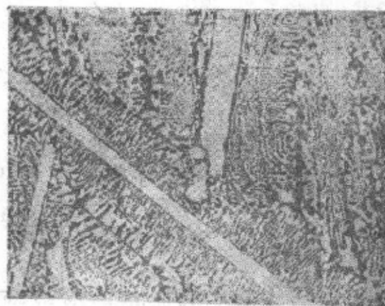
图4-21 过共晶白口铁的室温组织
