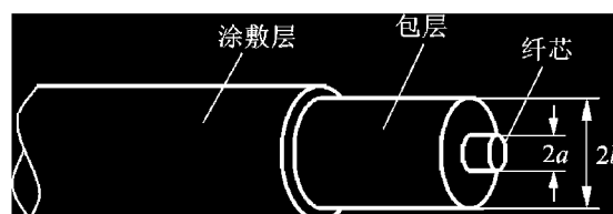
图 5-20 光纤的结构
