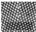
\text{Ni}_{100}\text{Al}_{100} 500ppm B 的小角晶界 (倾斜 7^\circ ) 的环状暗像。 晶界处为Ni富集区域，其宽度约为一个原子。 [D.A. Muller, M.J. Mills, Materials Science and Engineering, A260 (1999) 12-28]
