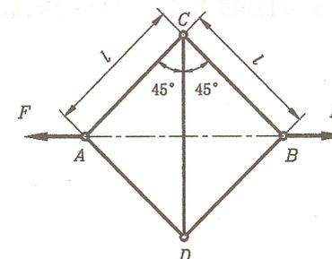
8、等截面刚架如图所示，各杆的弯曲刚度  $EI$  相同。试计算截面  $A$  的垂直位移  $\Delta_{Ay}$ （不计轴力和剪力对变形的影响）。
