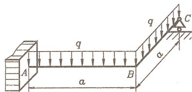
10、图示结构  $B$ 、 $C$  为球铰，材料均为  $A3$  钢。梁  $AB$  为圆截面，杆  $BC$  为矩形截面，已知： $[\sigma] = 160\text{MPa}$ ； $E = 200\text{GPa}$ ， $\sigma_p = 200\text{MPa}$ ，临界应力直线经验公式为  $\sigma_{cr} = 304 - 1.12\lambda$  (MPa)， $n_{st} = 3$ ， $d = 100\text{mm}$ ， $l = 2\text{m}$ ， $a = 1\text{m}$ ， $h = 48\text{mm}$ ， $b = 24\text{mm}$ ，试按  $AB$  梁的强度和  $CB$  杆的稳定性确定结构的许可均布载荷  $[q]$ 。
