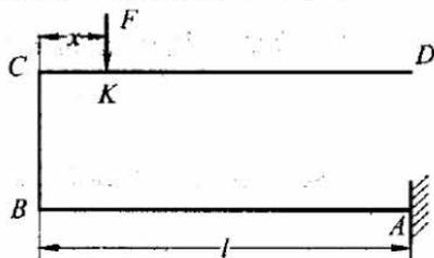
解 (1) 根据题意知,欲使 BC 段不发生转动,即要求 B 截面转角为零或 C 截面转角为零,作截面弯矩图如图(b)所示,在 C(或 B) 加单位力偶,如图(c)所示,(b)(c) 两图相乘得
