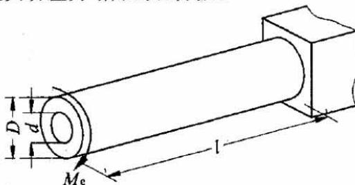
解 （1）求轴横截面上的最大切应力。代入扭转时最大切应力公式，得
