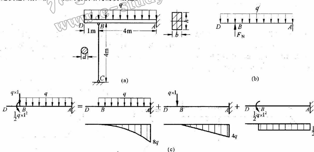
解 (1) 结构属于一次超静定。设  $BC$  杆轴力为  $F_N$ ,取图(b)所示相当系统,则变形协调条件为  $y_B = \Delta l_{BC}$ 。
