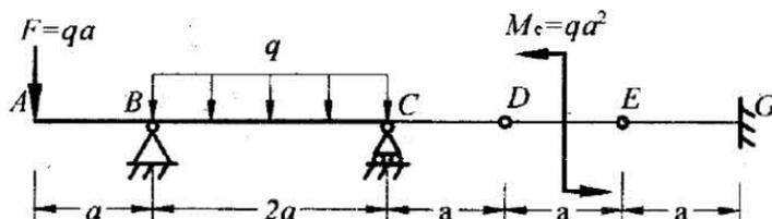
解 连续梁中包含两个中间铰，首先从  $D, E$  处截开，取  $DE$  段分析。根据静力平衡方程知  $F_{sD} = F_{sE} = qa$ 。因为  $ABCD$  段结构对称，载荷对称，故  $F_{By} = F_{Cy} = 2qa(\uparrow)$ ，且  $F_s$  图反对称， $M$  图对称。
