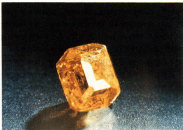
超高压力、超高温状態で窒素等の不純物を混ぜて合成した カラー・ダイヤモンド結晶（無機材質研究所）
