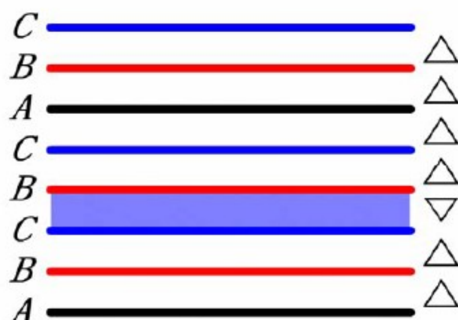
a) 抽出型; (b) 插入型 图 面心立方结构的堆垛层错
