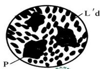
(3) 室温时亚共晶白口铁的相组成为：铁素体  $\alpha + \text{Fe}_3\text{C}$
