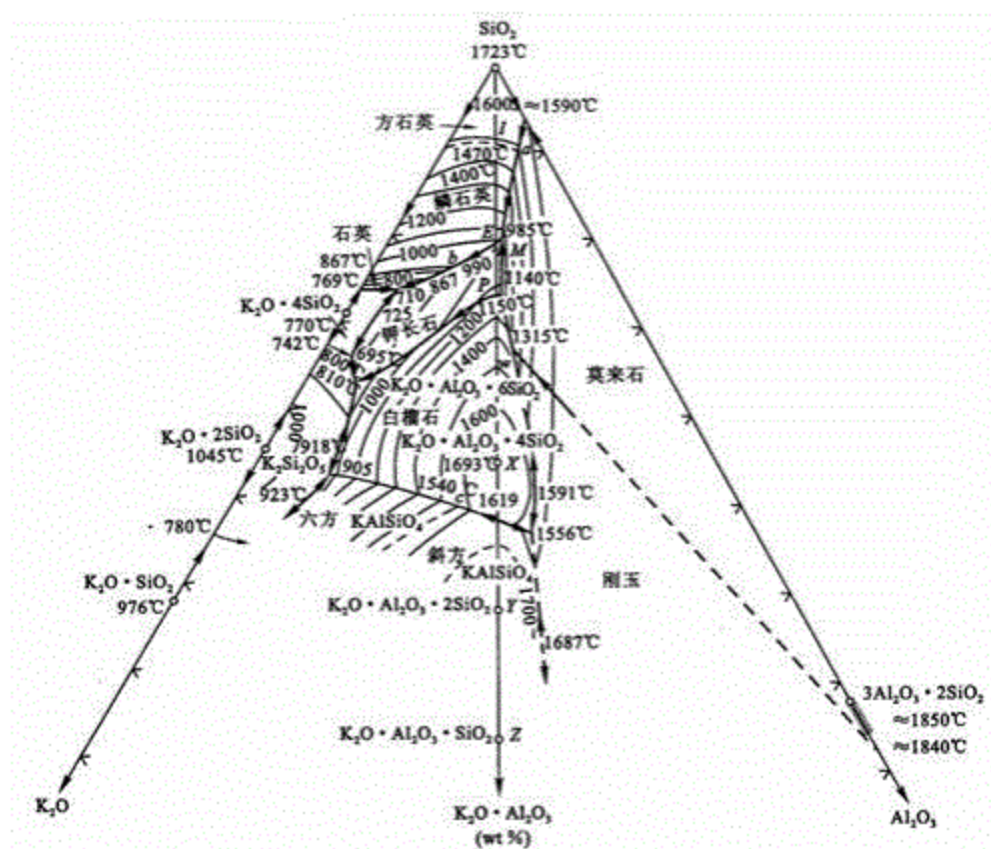
图6-50 K_2O-Al_2O_3-SiO_2 系统相图
