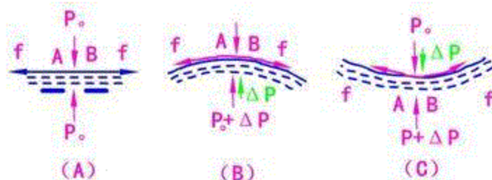
图5-11 弯曲表面上的附加压力的产生
