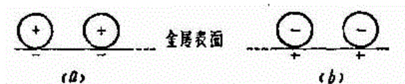
图5-16 金属表面的气体吸附膜中形成的电矩
