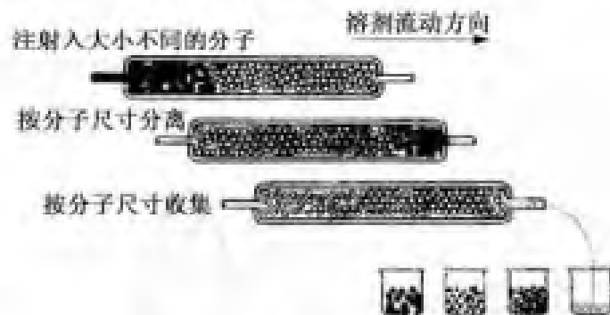
图 7-11 GPC 分离原理示意图
