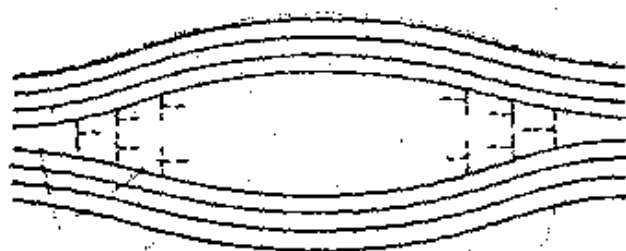
图15.51 I型裂纹的位错模拟。
