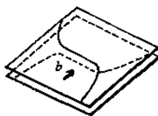
图2.18 具有长割阶螺型位错运动时位错偶的形成。
