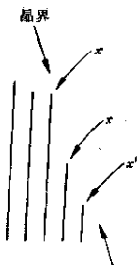
图3.24 晶界移动机制示意图。
