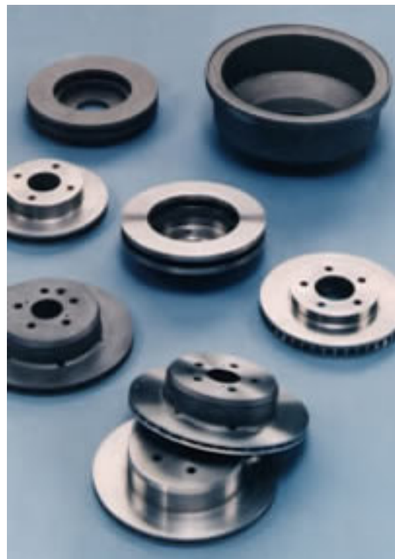
SiCp/Al, \text{Al}_2\text{O}_3 p/Al汽 车刹车盘，减重60% （丰田、福特和通用 汽车公司）
