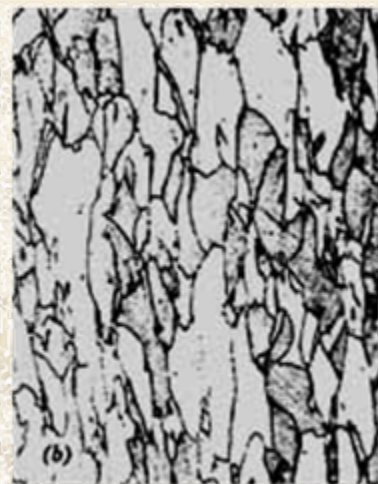
(b) 塑性变形后的粒长晶粒 (170×)
