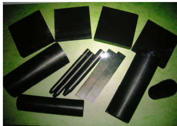
\text{B}_4\text{C}/\text{TiB}_2 复 相陶瓷防弹 片及喷嘴
