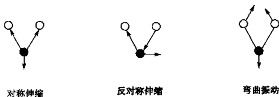
图 15-2 水分子的简正振动
