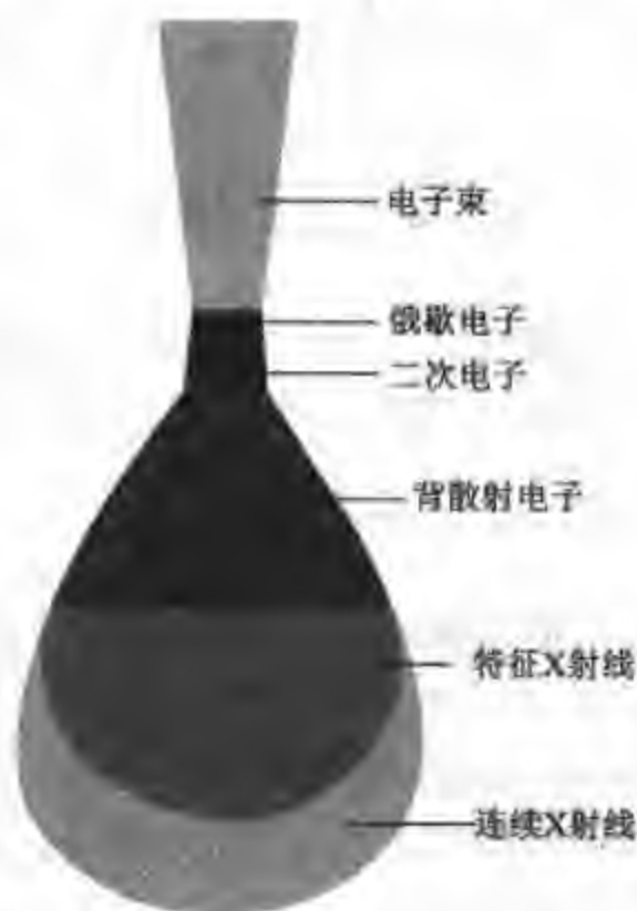
图 3-4 电子束与固体物质的作用体积
