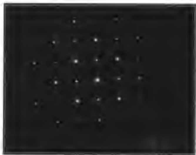
图 6-5 简单立方结构单晶的电子衍射花样
