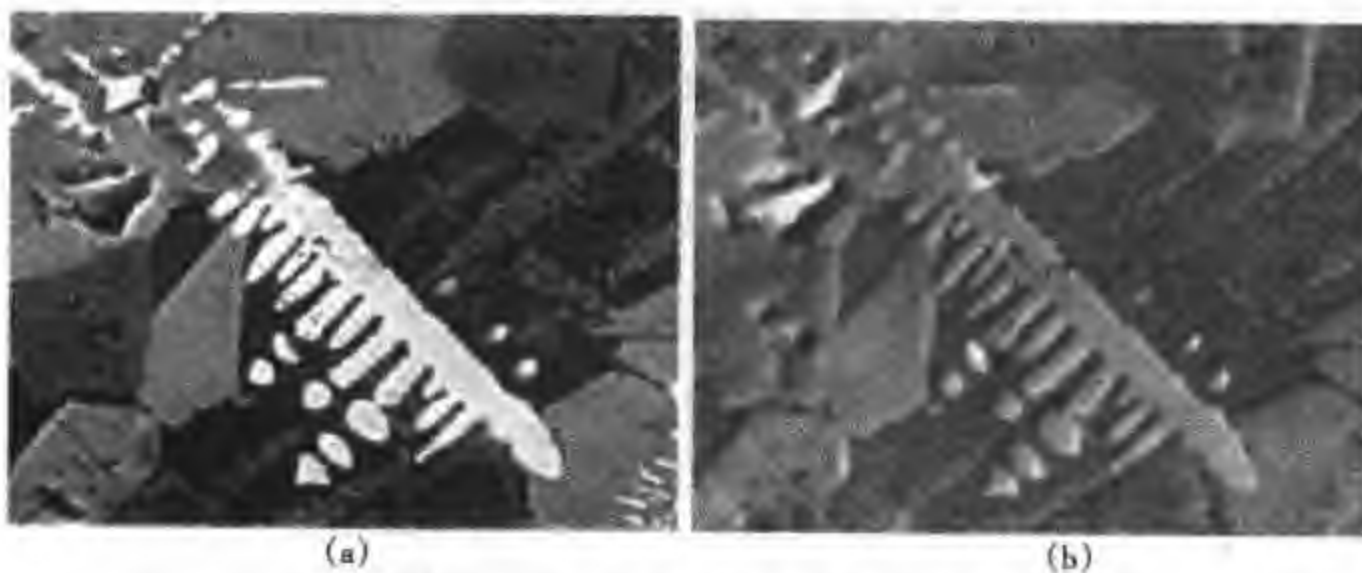
图 3-18 用背散射电子探头采集的图像 (a) 成分像 (b) 形貌像
