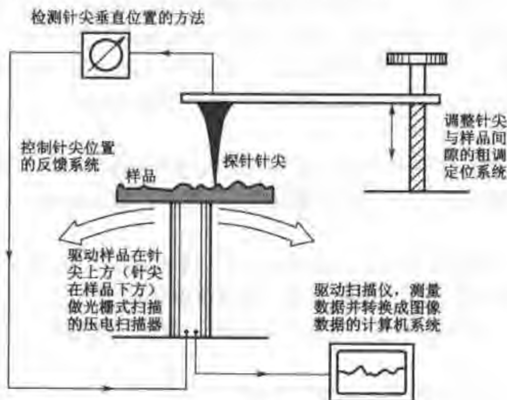
图 4-1 SPM 基本构成图
