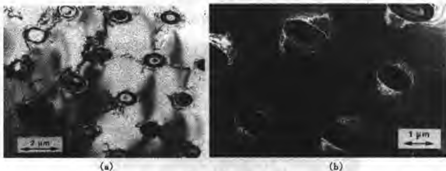
图 9-30 晶体的衍射衬度 (a)明场像 (b)暗场像
