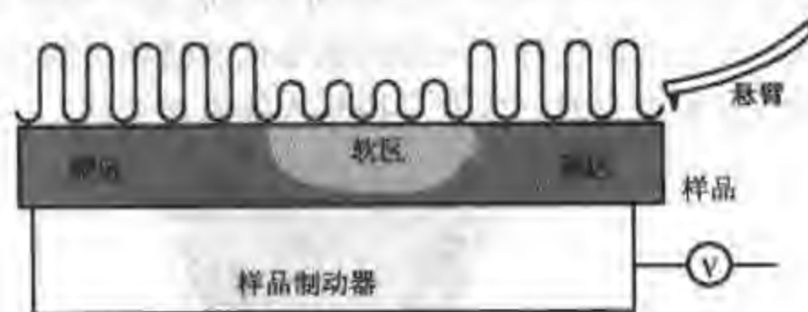
图 4-9 随样品表面力学性能改变的悬臂振幅
