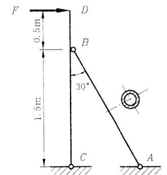
8、图示刚架在自由端受集中力  $F$  作用， $AB$ 、 $BC$  段的弯曲刚度均为  $EI$ 。现欲使  $C$  点的位移发生在沿力  $F$  的方向，试问  $F$  力应沿什么方向（即  $\alpha = ?$ ，不计轴力和剪力对变形的影响，规定  $\alpha$  角在  $0 < \alpha < \pi/2$  区间内变化）。（15 分）
