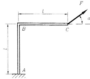
9、超静定结构如图所示，试求刚架内最大弯矩及其作用位置（不计剪力与轴力对变形的影响）。（15 分）
