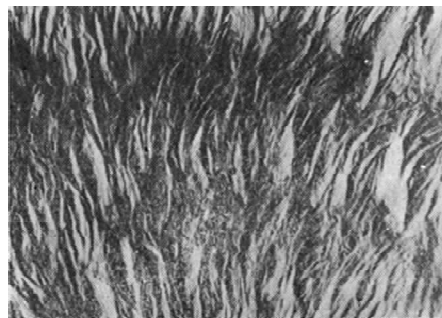
图 6-12 聚乙烯球晶内部晶片协同周期性 扭曲结构的电镜照片
