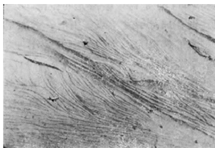
图 6-10 聚乙烯球晶内的片晶结构的电镜照片
