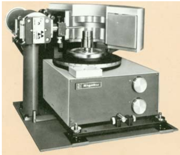
具有一维弯曲位置灵敏探测器的衍射仪也可探测宏观残余应力，且速度较快
