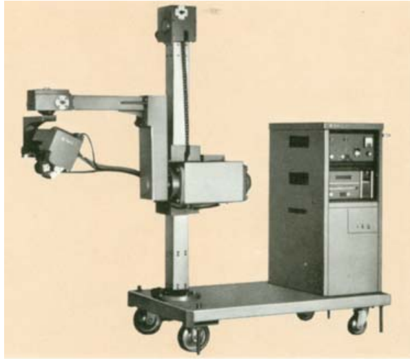
测定大工件残余应力的应力测定仪
