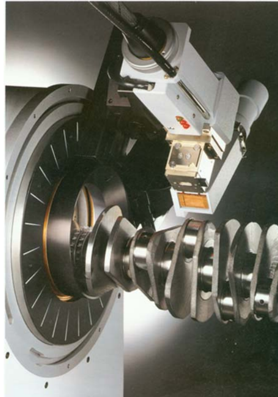
具有大的空心轴的衍射仪可探测曲轴的残余应力
