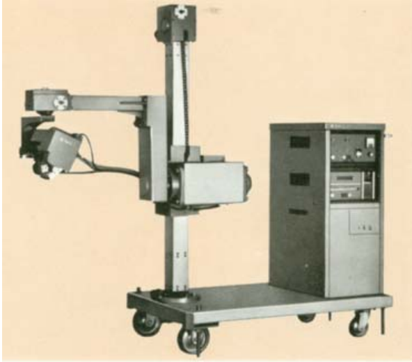
测定大工件残余应力的应力测定仪
