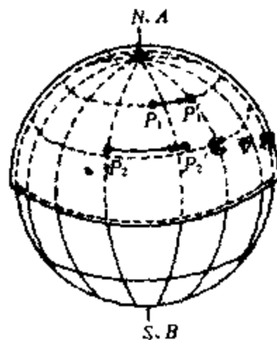
图1-52 晶体绕某一轴 AB 转动时, 球面投影上的极点 P_1 、 P_2 的相应转动
