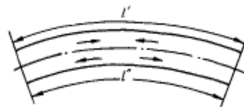
图 5.43 金属棒弯曲变形后的残留应力
