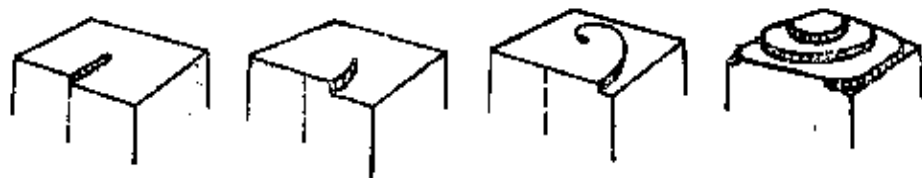
图 2-22 螺旋位错露头处生长螺旋线的形成
