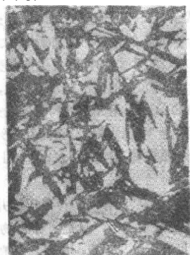
图 9-68 w_c = 1.3\% 的钢经 1150^\circ\text{C} 淬、 200^\circ\text{C} 回火 1h 后的金相显微组织 1000 \times
