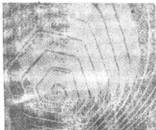
图 2-23 螺旋长大的 SiC 晶体
