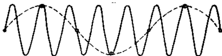
图 3-3-1 对应于两种不同波长( \lambda=4a 及 \lambda=4a/5 )的原子振动情况成的晶体来说,这两支格波是完全等价的,它们只能表示晶格振动的一种状态。实际上相应于波长 \lambda=4a 的格波波矢
